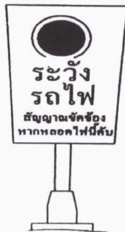
รูปที่ ๖๔ สัญญาณเตือนระวางรถไฟเครื่องกั้นถนนขัดข้อง
