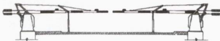
รูปที่ ๕๗ เครื่องกั้นถนนชนิดคานทำงานด้วยไฟฟ้า
