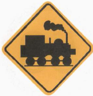
รูปที่ ๔๓ ป้ายเตือนทางข้ามทางรถไฟไม่มีเครื่องกั้น
