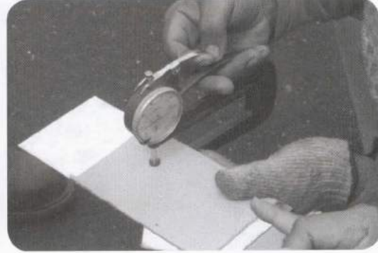
การตรวจสอบความหนาของเส้นจราจร
