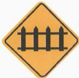
รูปที่ ๔๔ ป้ายเตือนทางข้ามทางรถไฟมีเครื่องกั้นทาง
