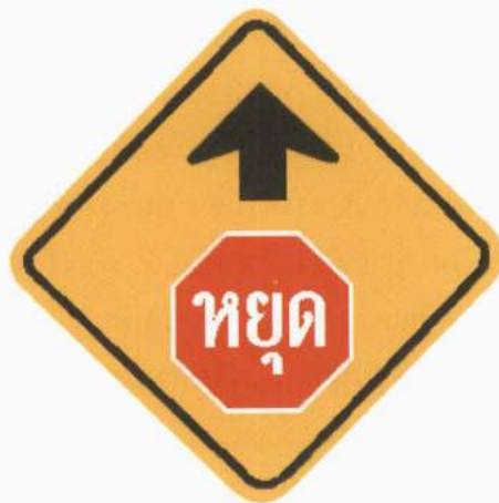
รูปที่ ๔๖ ป้ายเตือนทางข้ามทางรถไฟติดทางแยก
