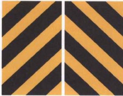
รูปที่ ๔๘ ป้ายเตือนสิ่งกีดขวาง
