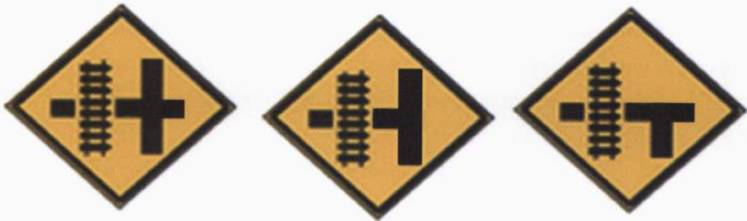
รูปที่ ๔๕ ป้ายเตือนทางข้ามทางรถไฟติดทางแยก
